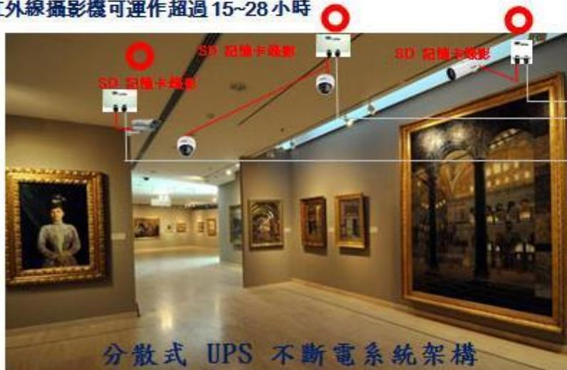
分散式 UPS 不斷電系統架構
