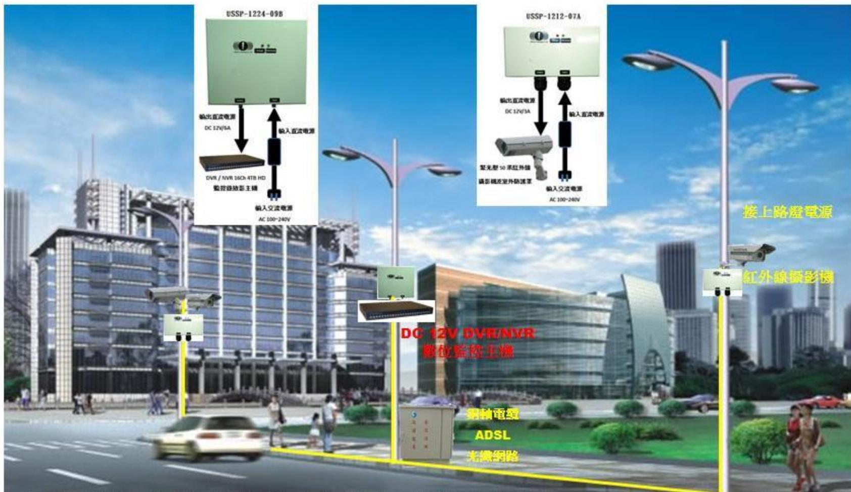
概要說明:透過路燈型室外有線監控系統,匯集所有線上監控畫面,先錄影於 DVR/NVR 主機,再回傳至監控管理中心。
