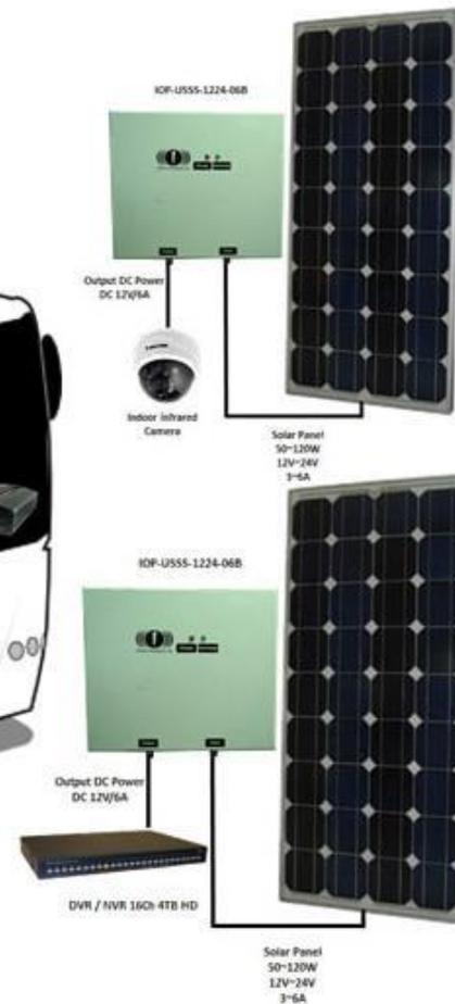
太陽能集能供電系統，將 Mobile DVR/NVR 延長為 24 小時運
