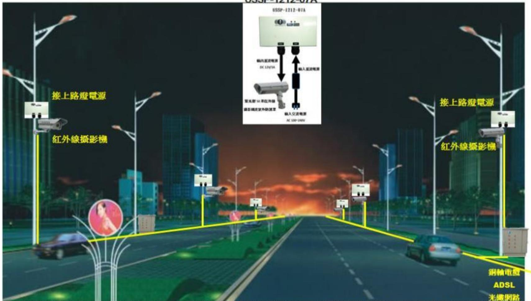
概要說明:透過路燈型室外有線監控系統,匯集所有遠端監控畫面,再將監控畫面導入 ADSL 或光纖網路骨幹回傳。
