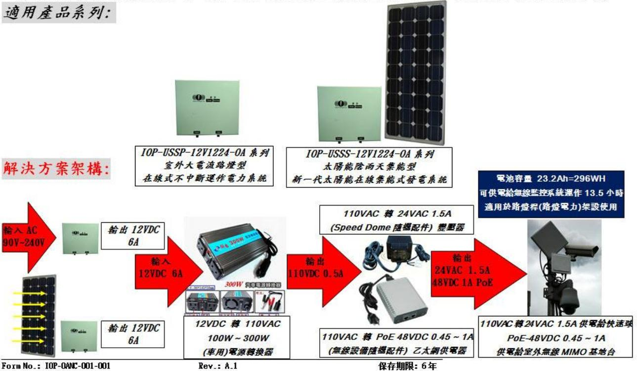
室外無線監控系統 搭配 路燈型與太陽能陰雨天集能型 UPS 電力系統
